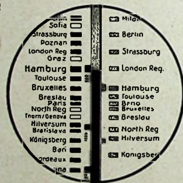
Fig. 3. De „dag en nacht”-schaal van de „Unix”. Overgang op de selectievere schakeling (fig. 2) geeft n.l. een vaste verstemming.
